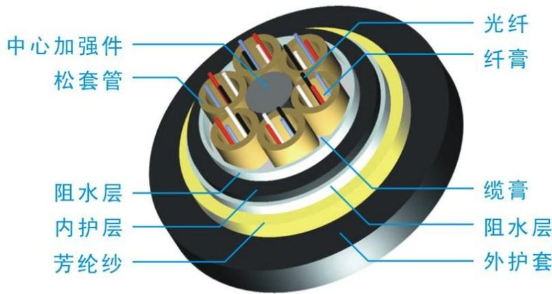
ADSS 光缆采用松套管绞式结构，将 250 $\mu$ m 光纤套入高模量材料制成的松套管中，松套管内填充防水化合物。松套管（和填充绳）围绕非金属中心加强芯（FRP）绞合成紧凑的缆芯，缆芯的缝隙充以阻水油膏。缆芯外挤制聚乙烯（PE）内护套，然后绞合起加强作用的芳纶，最后挤制聚乙烯（PE）外护套或耐电痕（AT）外护套。
